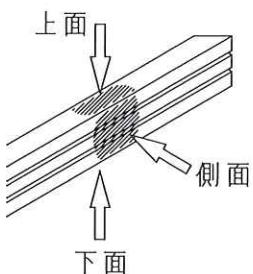
フレーム取付け面（上面、下面、側面）のほこり、油分、水分等をしっかりと除去してください。
