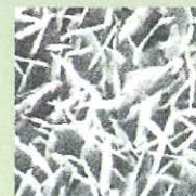
調湿材表面の微細構造電子顕微鏡写真 2000倍で撮影
