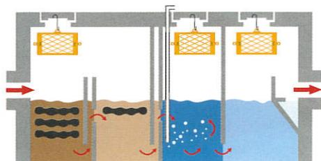
嫌気ろ床槽 ばっ気槽 沈殿槽
