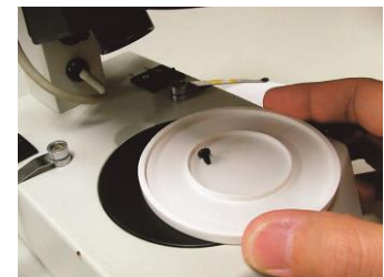
ABS樹脂製の丸型ステージは裏面が皿としても利用できます。
